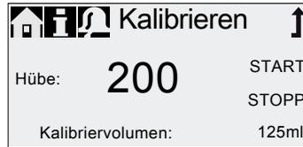
6. Saugschlauch aus dem Messbecher entfernen und das Restvolumen  $V_2$  ablesen (z. B. 170 ml).
