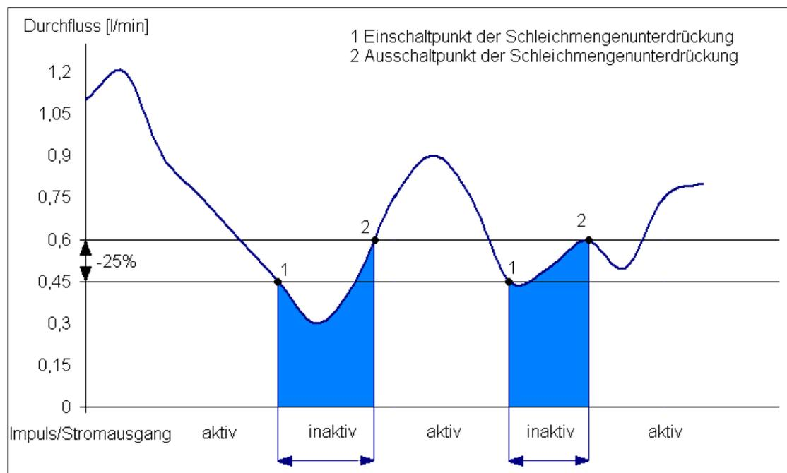
Abb. 13: Funktion der Schleichmengenunterdrückung am Beispiel 0,6 l/min
