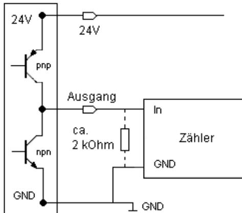
Abb. 22: Anschluss von digitalem Ausgang an Zählereingang
