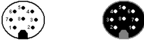
Abb. 9: Pinbelegung: Einbaustecker / Kupplung für 8-Pol
