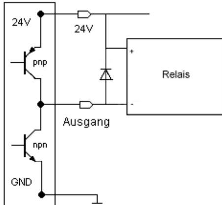
Abb. 21: Anschluss von digitalem Ausgang an Relais
