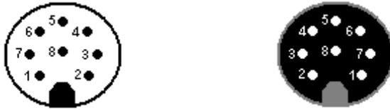
Abb. 10: Pinbelegung: Einbaustecker / Kupplung für 8-Pol
