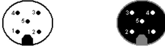
Abb. 8: Pinbelegung: Einbaustecker / Kupplung für 5-Pol
