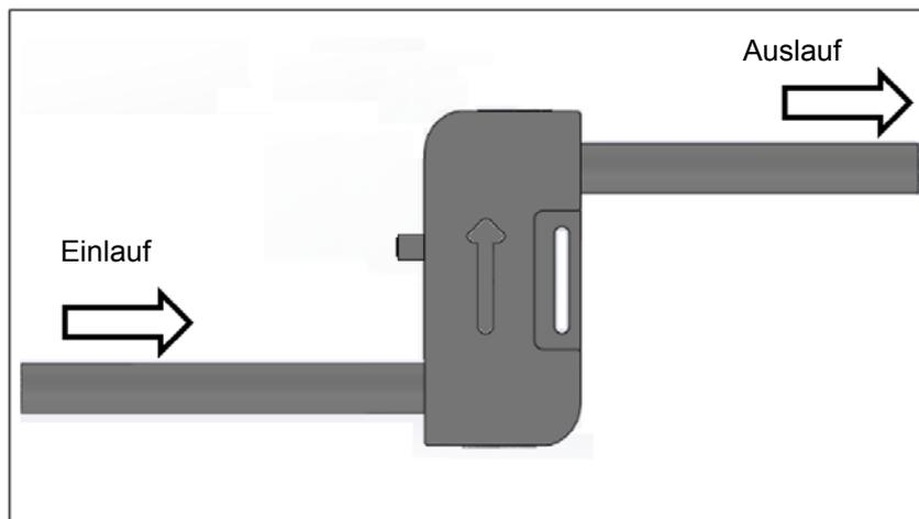
Abb. 3: ideale Einbaulage des Flowmax 42i in der getrennt Version
