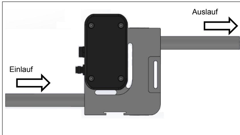
Abb. 2: ideale Einbaulage des Flowmax 42i in der Kompaktversion
